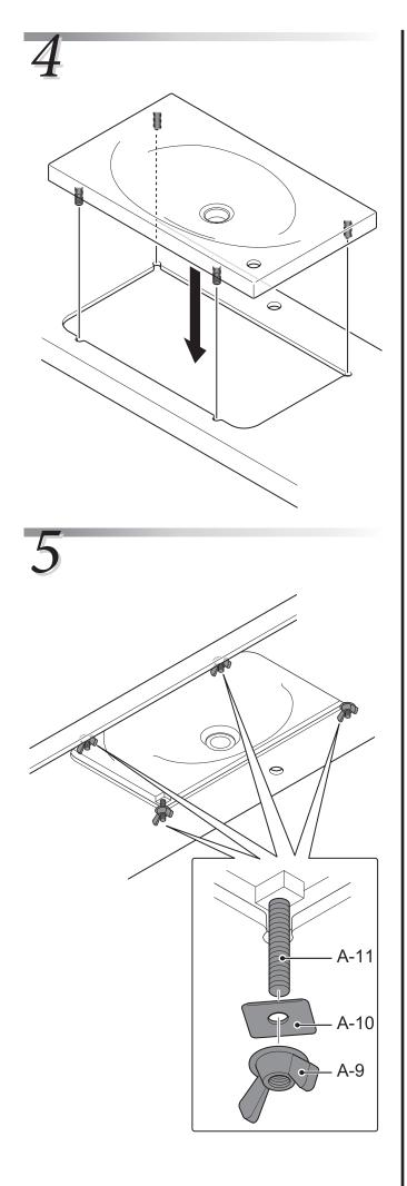
Attach the water discharge main unit Anbringen des Wasserabfluss-Hauptgeräts Fixez l'unité principale d'évacuation de l'eau Installare l'unità principale di scarico acqua
