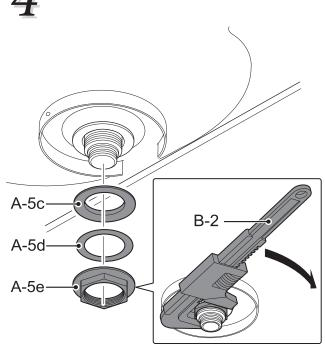
Attach the lighting Anbringen der Beleuchtung Fixez l'éclairage Collegare la luce
