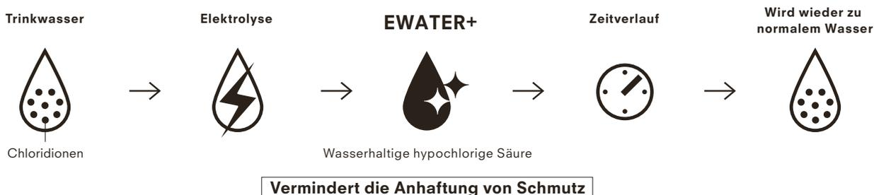
EWATER+ entsteht durch die Elektrolyse der Chloridionen im Trinkwasser. Es enthält keinerlei Chemikalien oder Reinigungsmittel. Im Laufe der Zeit wandelt sich EWATER+ wieder in seinen ursprünglichen Zustand zurück und ist als normales Wasser völlig umweltfreundlich.
