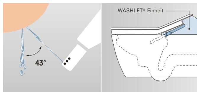
Um eine Verunreinigung der Düse zu vermeiden, wird sie schräg ausgefahren. Das verschmutzte Wasser wird in einem Winkel von 43–53° direkt in das WC-Becken geleitet. Dadurch bleibt die Düse sauber.
