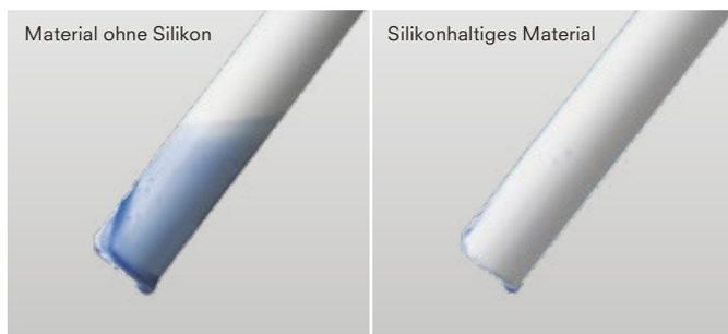
Die Düse ist mit einem speziellen silikonhaltigen Material beschichtet, das über schmutzabweisende Eigenschaften verfügt und sie in Kombination mit ihrer Selbstreinigungsfunktion stets sauber hält.
