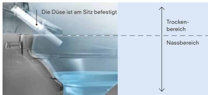
Die Stabdüse ist auf Grund des hochwertigen, silikonhaltigen Materials und der automatischen Reinigung mit EWATER+ nach jeder Nutzung, extrem resistent gegenüber Schmutzanhaftungen. Ferner gewährleistet die Düsenposition oberhalb der Keramik (innerhalb des Sitzes), dass die Düse kaum von Schmutz erreicht werden kann. Auch wenn sie selbstreinigend ist, kann die Düse zusätzlich einfach und problemlos manuell gereinigt werden.
