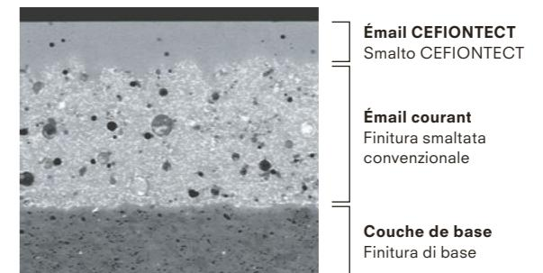
Micrographie WC CEFIONTECT \*1µm=0,001mm
