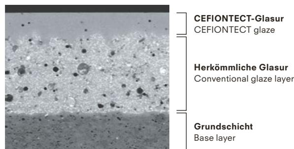
CEFIONTECT WC-Mikrograph \* 1 µm=0,001 mm
