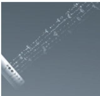
Les mouvements de la buse rétractable permettent un nettoyage efficace sur une zone plus étendue.
