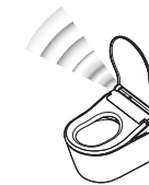
Sensore di presenza A (Rileva le variazioni di calore)
