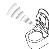
Sensore di presenza B (Rileva la presenza di una persona in piedi nelle vicinanze)
