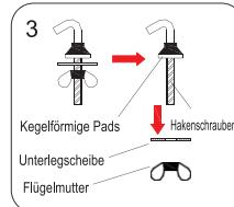
Von den Hakenschraubenschrauben am Produkt die Unterlegscheibe und die Flügelmutter entfernen, sodass nur die kegelförmigen Pads auf den Hakenschrauben verbleiben.
