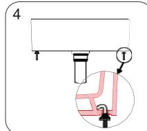
Die Hakenschrauben werden um die Montageöffnung an der Unterseite des Waschbeckens auf beiden Seiten verteilt. Kegelförmige Pads an den Montagelöchern ausrichten.
