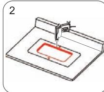
Fori di montaggio lungo il contorno, tagliare il contorno degli scarichi e del rubinetto con la dima posizionata correttamente, tagliare i fori di montaggio del rubinetto
