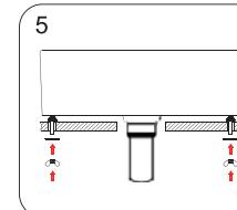
Le lavabo soigneusement relevé, ajoutez lentement le plan après avoir aligné les trous de montage pour boulon à crochet. En suivant la méthode illustrée dans le tableau le lavabo sera fixé
