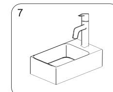
Sobald die Dichtmasse ausgehärtet ist, kann der Waschtisch bestimmungsgemäß installiert werden.
