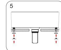
Nach Ausrichten an den Montagelöchern das Waschbecken auf den Waschtisch setzen und das Waschbecken wie gezeigt befestigen.
