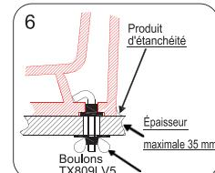
L'épaisseur maximum du plan-vasque est de 35 mm. Un plan épais influera la solidité de l'installation. Après installation, utiliser un produit d'étanchéité autour du bord des lavabos et des plans en contact
