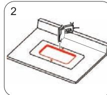
Les trous de montage sur le contour découpe du contour évacuations et robinet avec dimensions du plan correctement installé trous de montage du robinet
