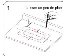
Selon l'endroit d'installation, installer le lavabo pour le positionnement en forme de feuille.
