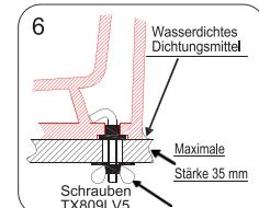
Der Waschtisch sollte höchstens 35 mm dick sein. Ist die Platte stärker, kann die Stabilität beeinträchtigt sein. Nach dem Einbau mit wasserdichtem Silikon alle Kontaktstellen zwischen Waschbecken und Waschtisch sowie alle Kanten abdichten.
