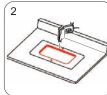
Um den Ausschnitt herum Montagelöcher bohren, Öffnungen für Abfluss und Wasserhahn schneiden.
