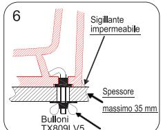
Lo spessore massimo del piano deve essere di 35 mm, in caso contrario si compromette la tenuta dell'installazione. Dopo l'installazione utilizzare un sigillante impermeabile intorno al bordo del lavandino e sul piano a contatto con esso
