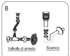
Tubi di collegamento di carico e scarico
