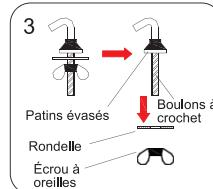
Retirez les boulons de l'intérieur du produit emballage rondelle et écrou à oreilles déposés, en ne laissant que les patins coniques sur les boulons à crochet.
