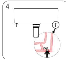
Les boulons à crochet ont été placés autour du trou de montage dans le fond des lavabos des deux côtés et réglez le sens du patin conique dans le sens correspondant aux trous de montage.
