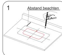
Die Schablone je nach Einbauort positionieren und den Ausschnitt für das Waschbecken anzeichnen. Montagelöcher wie dargestellt einzeichnen.
