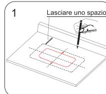
Secondo la posizione di installazione, posizionare il foglio; marcate i bordi del foglio per il contorno del lavabo con i fori di montaggio indicati nella figura
