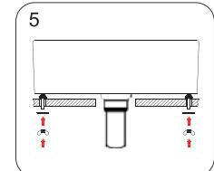
Appoggiare il lavabo sul piano e allineare i fori di montaggio con i bulloni a gancio, fissare il lavabo come mostrato nella figura
