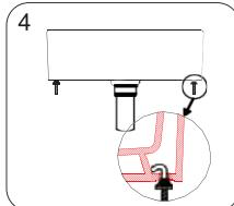
Inserire i bulloni a gancio nel foro di montaggio nella parte inferiore del lavabo su entrambi i lati e regolare la direzione delle guarnizioni di appoggio coniche in modo coerente con i fori di montaggio.
