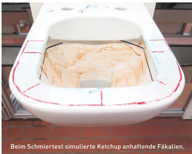
Beim Schmiertest simulierte Ketchup anhaftende Fäkalien.
