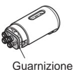
(1) Mantenere la bacchetta con la mano e slittare l'ugello di spruzzatura di ricambio lungo la guida, e quindi spingerlo verso l'interno.
