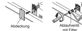
**6** Mit einem Gegenstand wie z. B. einer Zahnbürste reinigen.
